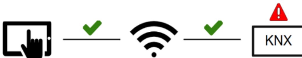
Abbildung 6 – KNX-IP-Interface meldet einen Fehler
